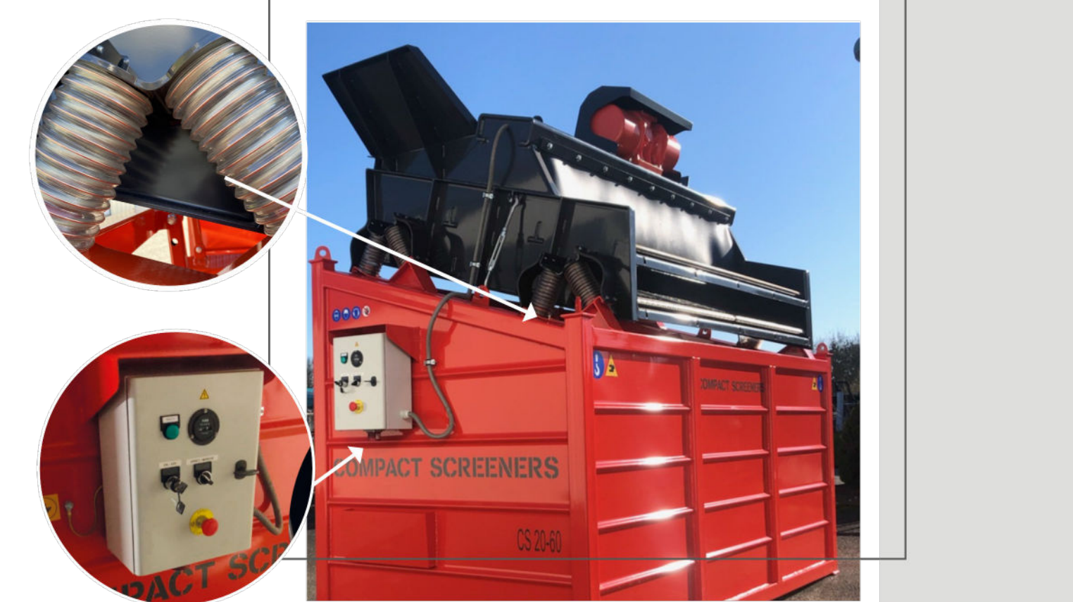
Crible vibrant : 2 fractions à deux Tamis
