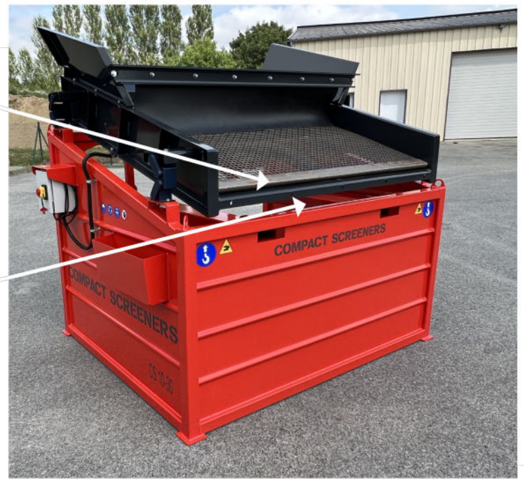
Crible vibrant : 2 fractions à un Tamis
