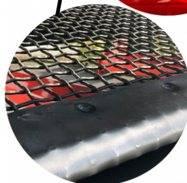
**Crible vibrant : 2 fractions à deux tamis**
